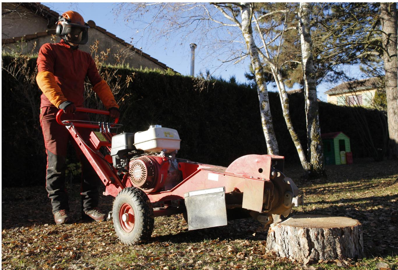
*Rogneuse de souche avec disque et pastille de tungstène*
