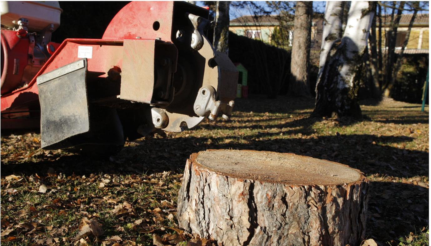
Rogneuse de souche avec disque et pastilles de tungstène
