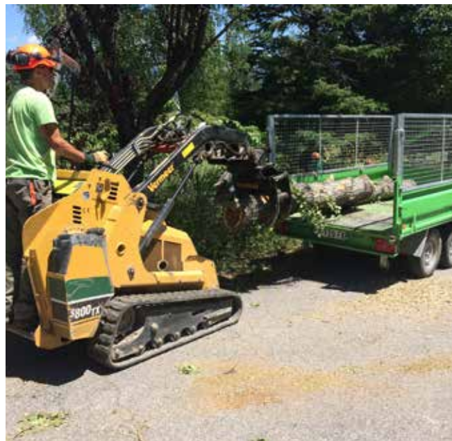
Chargement en bois d'une remorque avec porte-outils sur chenilles
